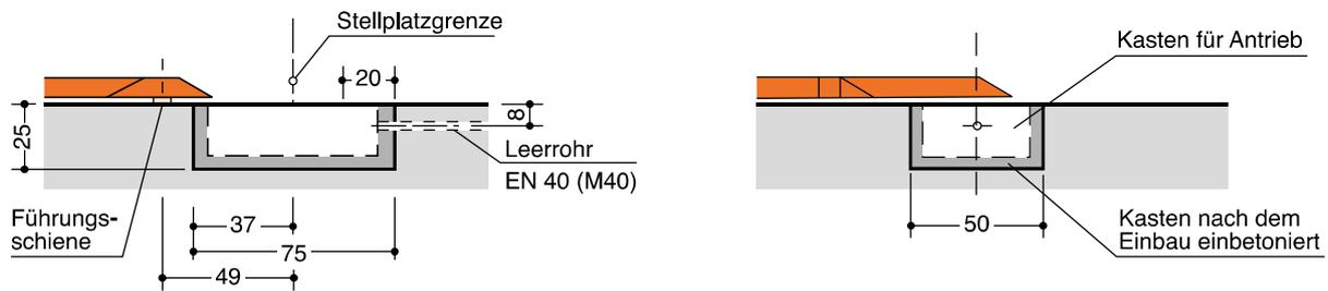
Das Antriebsgehäuse bietet keinen vollständigen Schutz gegen eindringendes Fließwasser. Es muss sichergestellt werden, dass kein Fließwasser in den Bereich des Antriebs gelangt.
